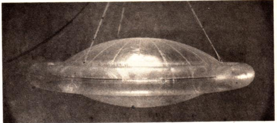
Le Langley Research Center de la NASA développe de nouvelles formules de satellites de communications. Passifs, comme les Echo I et II, ils seraient constitués par une sorte de lentille entourée d'un tore. Notre photo montre un essai de gonflage d'un modèle de 6 m. de diamètre. Le véritable satellite aurait 71 m. de diamètre, une fois gonflé sur orbite, et serait stabilisé par gradient de gravité afin de toujours présenter une surface maximale à la Terre.
