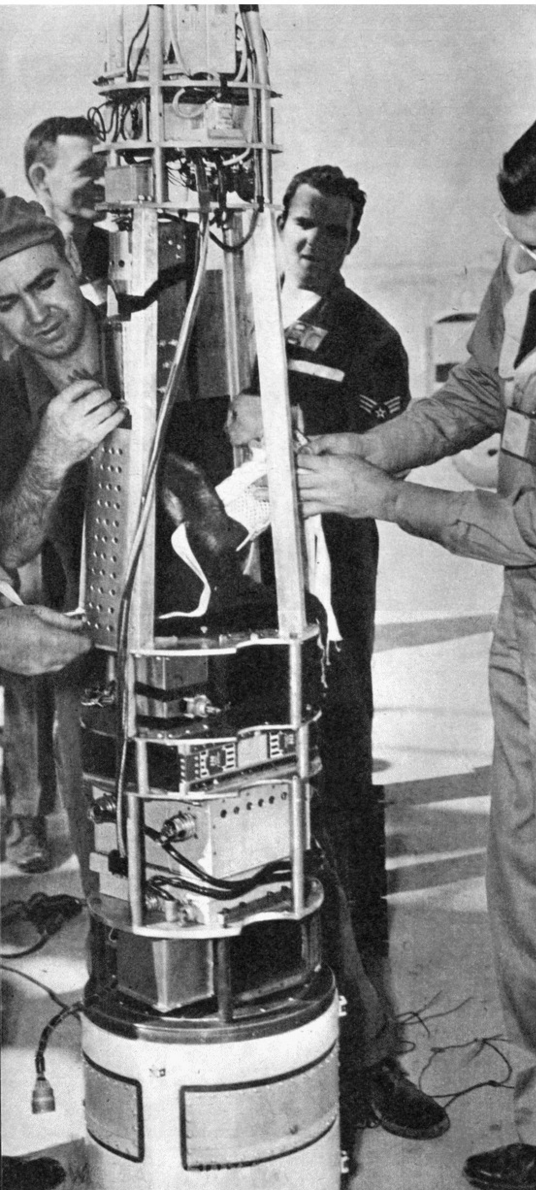
MIKE INSTALLE DANS L' « AEROBEE III ». LE CONE DETACHABLE EST MUNI D'UN PARACHUTE. Photos U. S. Air Force.
