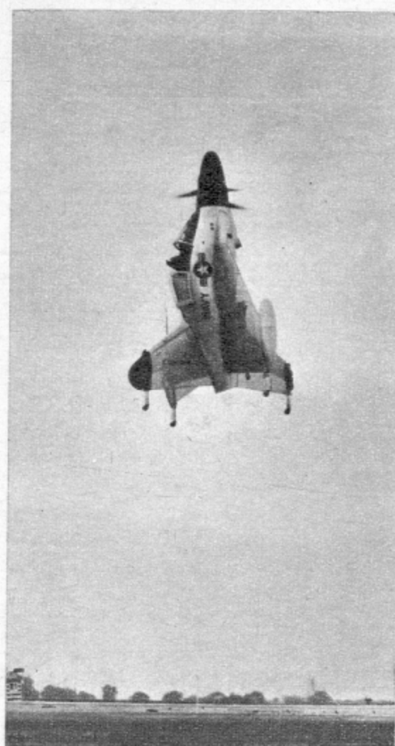
A gauche, la célèbre V2, n'était qu'un projectile-fusée, lancé une fois pour toutes et non récupérable, et comportant un appareillage sommaire de guidage automatique. A dr., dernier-né de l'US Navy, le Convair XFV-1, avion à hélice décollant sur la queue.
